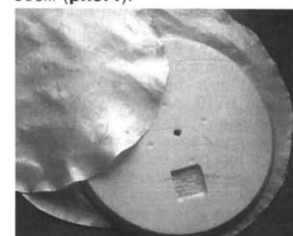
Затем эту стеклоткань отжигаем в течение нескольких минут на газовой печке под вытяжкой. Это делается для удаления промасливающих веществ, которыми ткань пропитывается при производстве. Потом на всех трех кусках делаем прорези под "уши" кронштейна.
