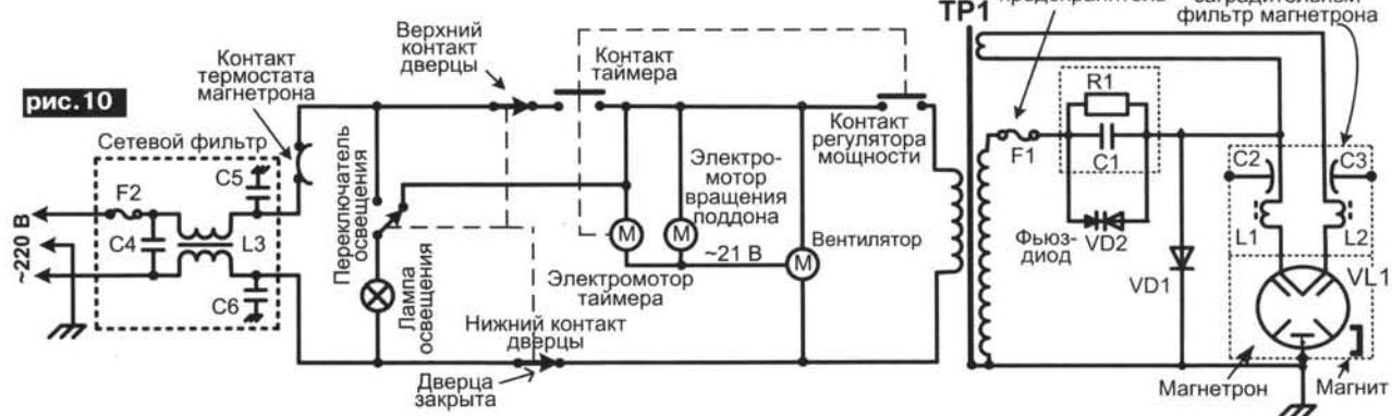
трансформатора ~220 В. Именно там установлены: сетевой фильтр, не пропускающий СВЧ излучение в электросеть; механический таймер, с регулятором мощности работающий от электромотора; нижний и верхний выключатели дверцы (рис. 11); термостат, лампочка освещения рабочей камеры со своим переключателем от дверцы; вентилятор и электромотор вращения тарелки. С обмотки вентилятора обычно делают отвод, который обеспечивает питанием ~21 В электромоторы таймера и вращения поддона (рис. 10).
