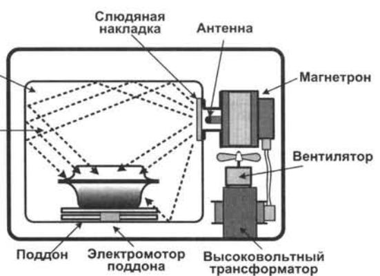
**Магнетрон** – главный элемент (генератор) микроволновых печей. Он генерирует частоту 2450 МГц, мощностью 550...850 Вт без каких-либо дополнительных усилителей. Внешний вид типового магнетрона Samsung OM75P(31) и назначение его основных элементов показаны на **рис. 6**. Авнутренне устройство магнетрона показано на **рис. 7**.
